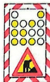
Semnalizarea unui utilaj care se deplasează lucrând
