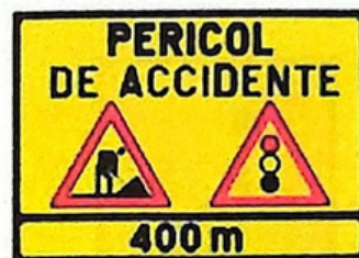
Presemnalizarea unui sector cu circulație alternantă
