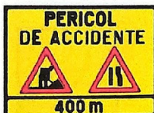
Presemnalizarea unui sector cu circulație alternantă
